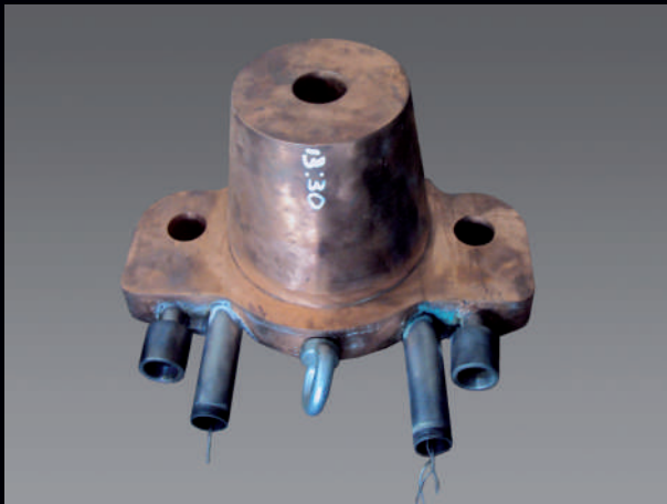
OPTISAVE 传感器在铜制水冷熔渣口布设
