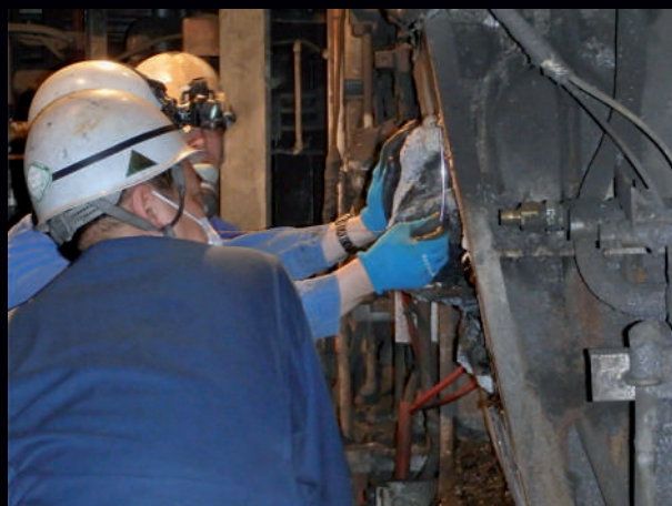
有芯感应保温炉磨损确认及显示
