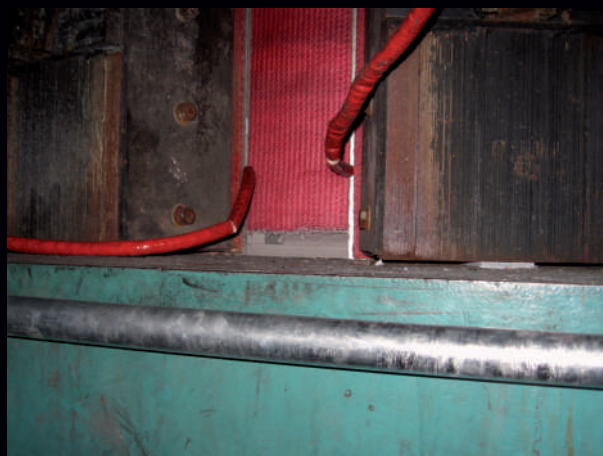
SAVESEARCH ® 电极在一个10吨炉上的电路连接
